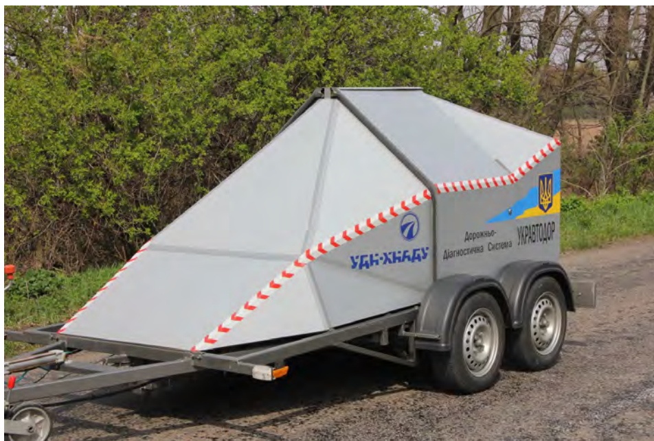
Рисунок 16 – Устаткування УДН-ХНАДУ для оцінки міцності дорожньої конструкції за методом FWD
