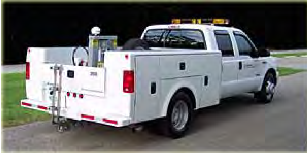
Рисунок 15 – Установка на базовом автомобиле фирмы Dynatest Dynatest 8000 TMD (Truck Mounted Deflectometer)
