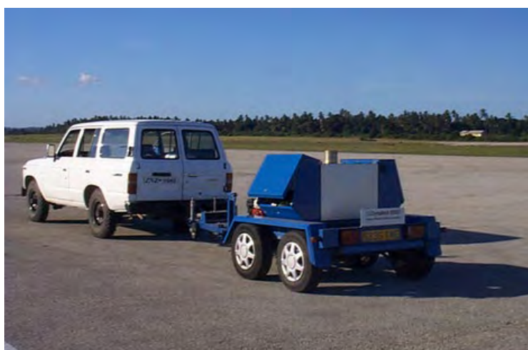
Рисунок 14 – Установка фирмы Dynatest – Dynatest Model 8082 Heavy Weight Deflectometer
