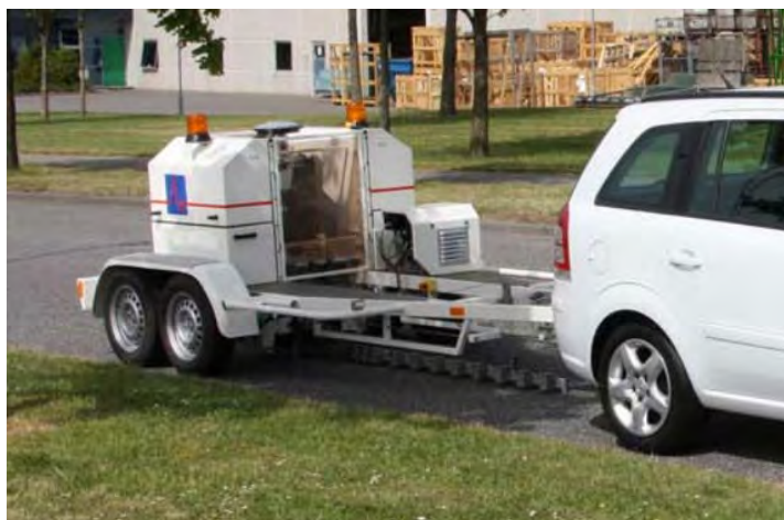
Рисунок 12 – Установка фирмы Grontmij – PRIma-X FWD trailer
