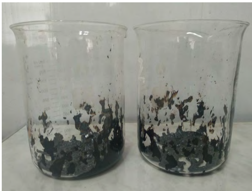
Рисунок 2 – Зовнішній вигляд стаканів після визначення показника стікання в'язучого у випадку ЩМАС-15 на основі вихідного бітуму БНД 70/100 без будь-яких добавок
