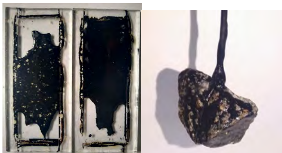
Рисунок 14 – Зчеплення бітуму модифікованого 3 % Kraton D1101 з поверхнею мінеральних матеріалів до прогрівання
