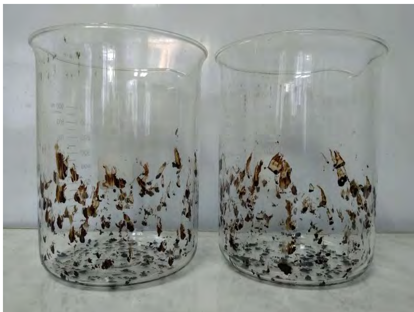
Рисунок 3 – Зовнішній вигляд стаканів після визначення показника стікання в'язучого у випадку ЩМАС-15 на основі вихідного дорожнього бітуму марки БНД 70/100 з целюлозною добавкою «iFiber»
