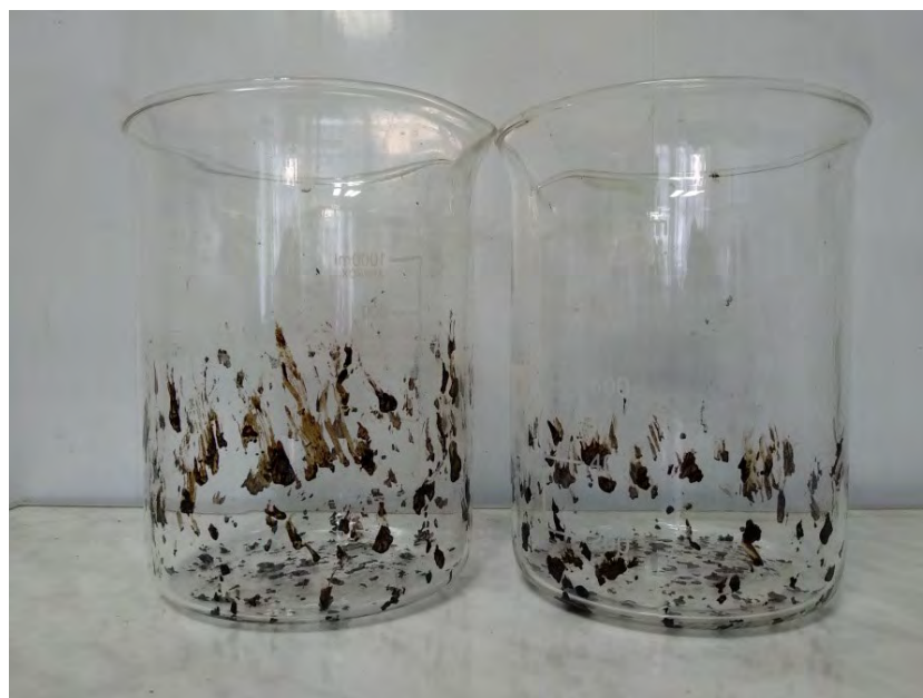
Рисунок 4 – Зовнішній вигляд стаканів після визначення показника стікання в'язучого у випадку ЩМАС-15 на основі вихідного дорожнього бітуму марки БНД 70/100 з 0,6 % добавки «DUROFLEX®-SMA» (за відсутності целюлозної добавки «iFiber») витриманих 30 хвилин при температурі 170 °С
