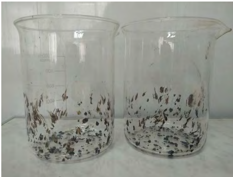
Рисунок 5 – Зовнішній вигляд стаканів після визначення показника стікання в'язучого у випадку ЩМАС-15 на основі вихідного дорожнього бітуму марки БНД 70/100 з 0,8 % добавки «DUROFLEX®-SMA» (за відсутності целюлозної добавки «iFiber») витриманих 30 хвилин при температурі 170 °С
