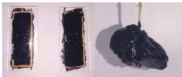
Рисунок 13 – Зчеплення бітуму модифікованого 3 % Honeywell Titan 7686 з поверхнею мінеральних матеріалів після прогрівання
