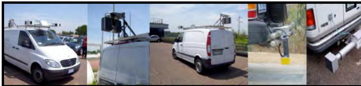
Рисунок 17 – Система мобільного картографування Road – Scanner
