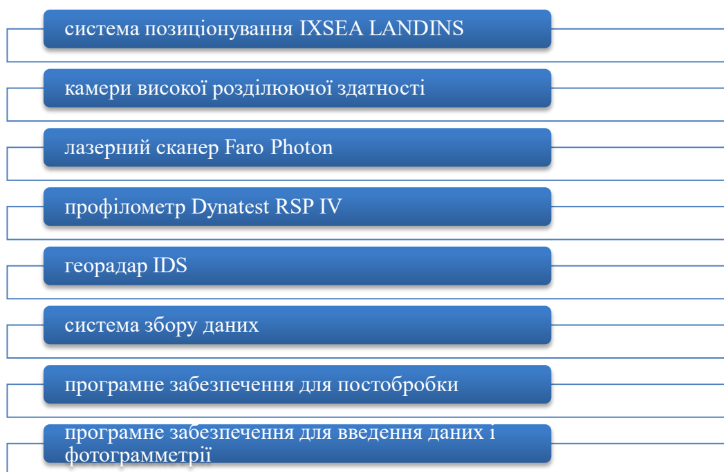
Рисунок 18 – Компоненти системи Road – Scanner
