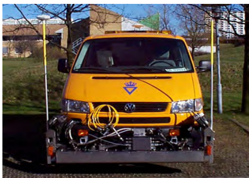
Рисунок 10 – Установка сканування покриттів датського дорожнього інституту
