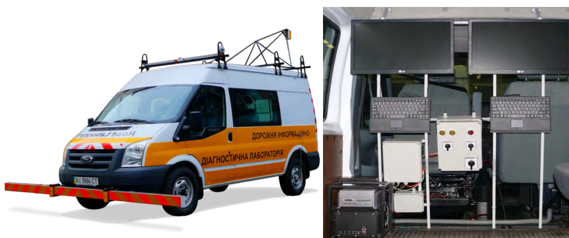
Рисунок 15 – Загальний вигляд ЛВС-3 змонтованого на автомобілі «Ford Transit»
