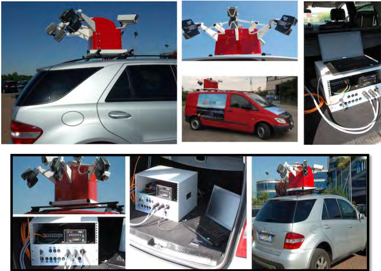
Рисунок 19 – Система моніторингу автодоріг TERRA для дорожніх служб
