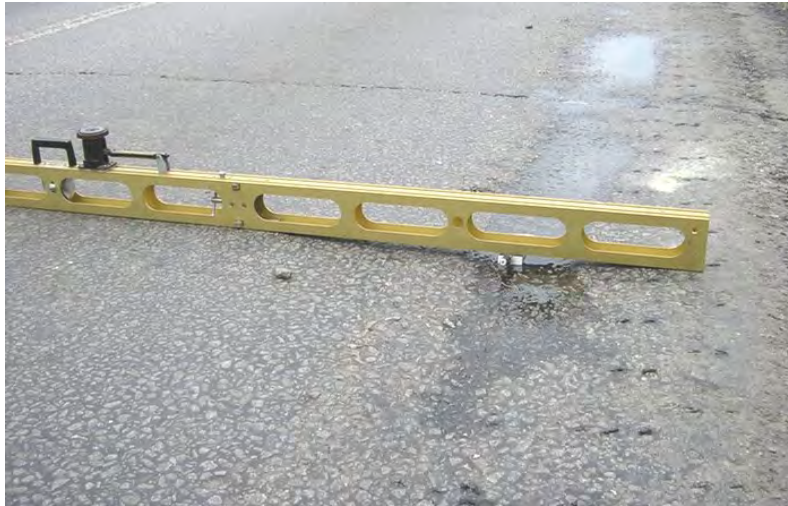
Рисунок 27 – Вимірювання рівності за допомогою 3-х метрової рейки
