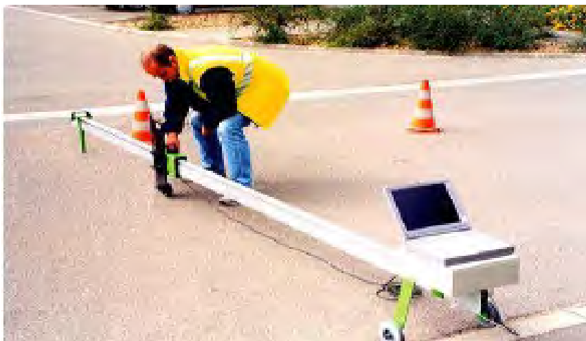
Рисунок 6 – Цифровий вимірювач поперечного профілю VEC450
