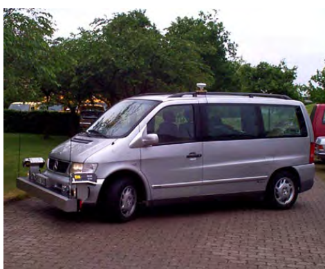
Рисунок 11 – Прилад сканування покриттів фірми „GREENWOOD ENGINEERING” зразка 2000 року
