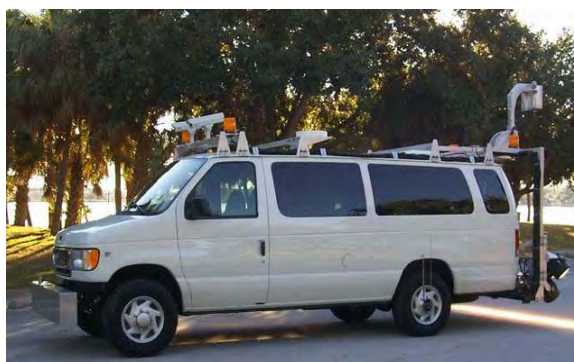
Рисунок 8 – Лабораторія фірми ІСС з лазерним сканером та обладнанням для запису поверхні та облаштування дороги
