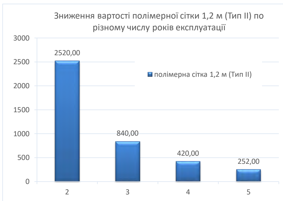
Рисунок 8 – Зниження вартості полімерної сітки 1,2 м (Тип II) по різному числу років експлуатації
