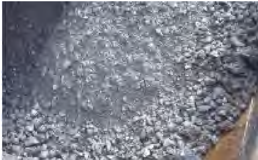
Рисунок 6 – Гранулометрична сегрегація суміші при розвантаженні
