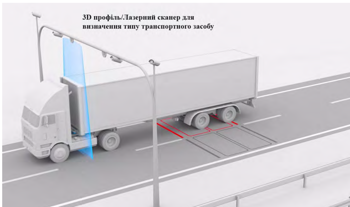
Рисунок 10 – Додаткові системи визначення типу транспортного засобу лазерним сканером
