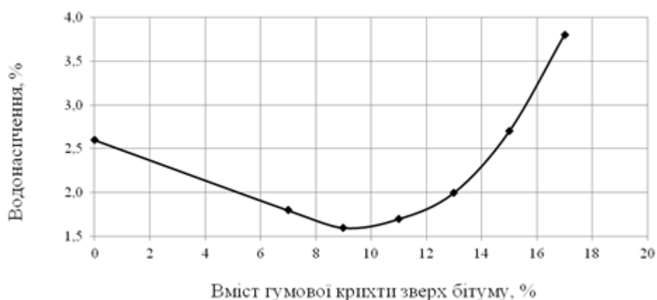
Рисунок 6 – Залежність водонасичення від вмісту гумової крихти у складі ЩМА-15
